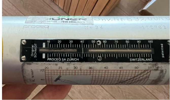
9 pav. Nustatytas denginio plokštės betono stiptis
