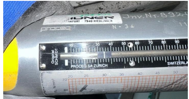
22-23 pav. Nustatytas denginio plokštės betono stiptis
